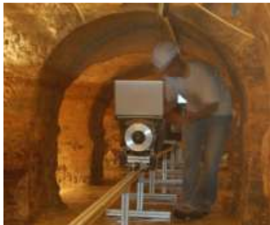
Figura 6 – Sistema de aquisição GIM em operação nas Galerias Romanas de Lisboa
