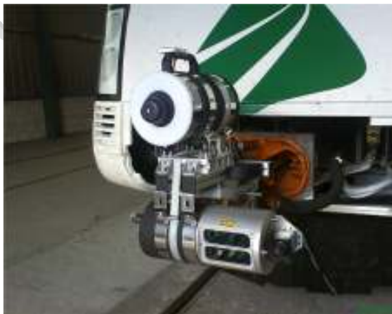
Figura 5 – Sistema de aquisição montado num comboio de alta velocidade espanhol
